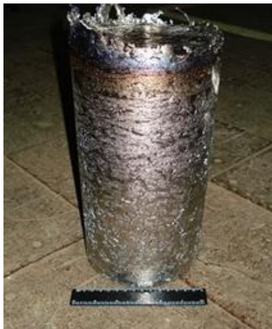
Рисунок 5.12 – Слиток гафния из оборотов 1-3 класса диаметром 150 мм и массой 74,2 кг, выплавленный в электронно-лучевой гарниссажной печи [116]
