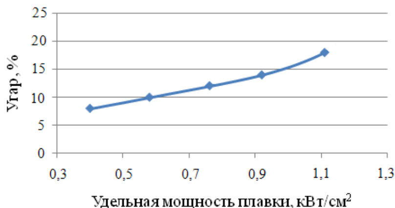
Рисунок 3.12 – Зависимость угара металла основы от удельной мощности плавки
