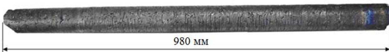
Рисунок 5.4 – Внешний вид слитка гафния из оборотов 1-3 класса, выплавленный в электронно-лучевой печи ЭДП-07/500 с промежуточной емкостью, диаметром 75 мм и длиной 980 мм, масса слитка 49,7 кг
