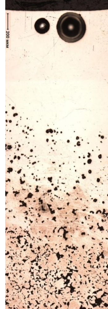
Рисунок 3.8 – Микроструктура швов электронно-лучевой сварки брикетов из электролитического порошка гафния, сваренных по разным режимам
