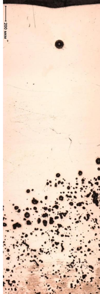
Рисунок 3.8 – Микроструктура швов электронно-лучевой сварки брикетов из электролитического порошка гафния, сваренных по разным режимам
