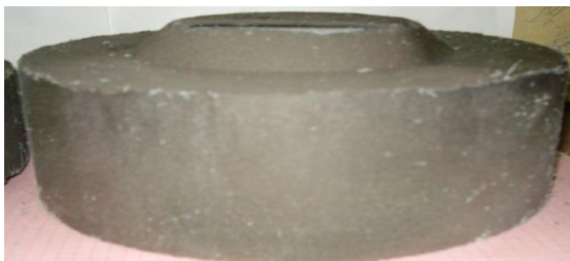
Рисунок 4.1 – Внешний вид промышленного брикета диаметром 200 мм
