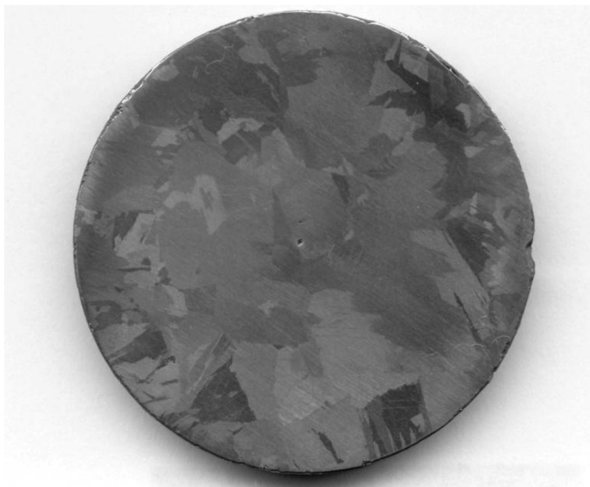
Рисунок 5.6 – Макроструктура слитка гафния диаметром 75 мм, выплавленного в электронно-лучевой печи с промежуточной емкостью
