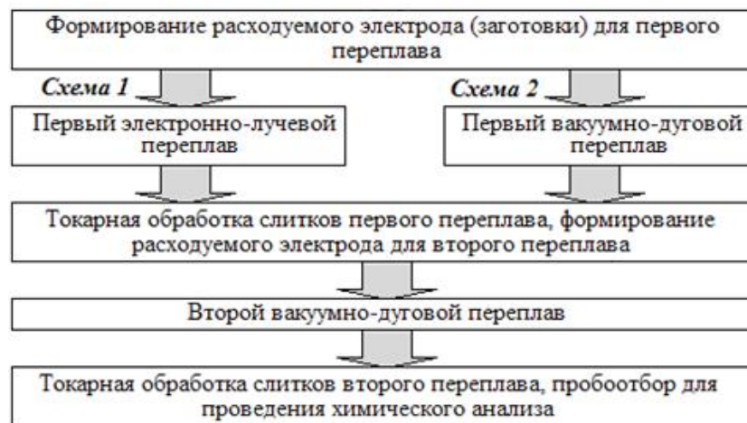
Рисунок 1.8 – Обобщенная технологическая схема выплавки слитков гафния [50]
