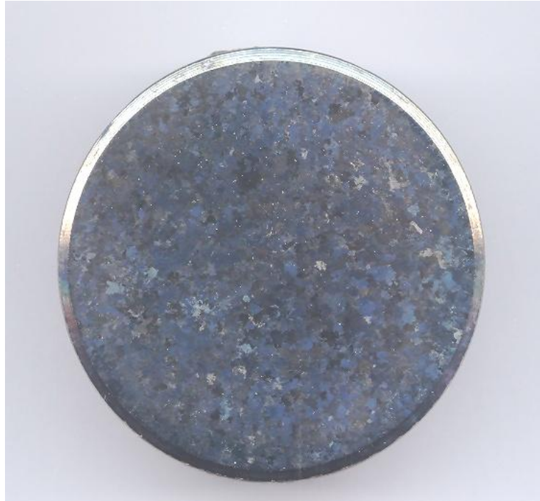
Рисунок 5.7 – Макроструктура слитка гафния диаметром 110 мм из оборотов 1-3 класса, выплавленного по схеме ЭЛП-ВДП
