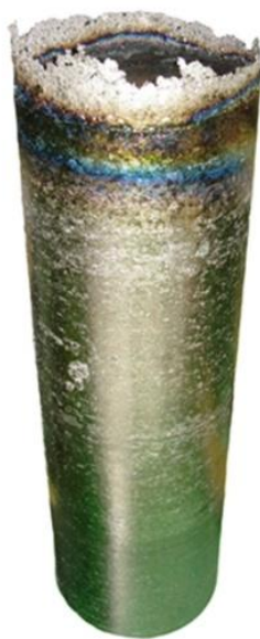
Рисунок 4.10 – Внешний вид слитка гафния диаметром 320 мм, выплавленного двукратным вакуумно-дуговым переплавом
