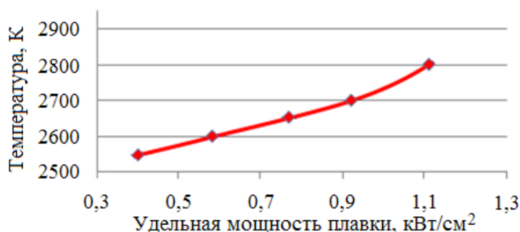
Рисунок 3.11 – Зависимость температуры поверхности расплава от удельной мощности плавки
