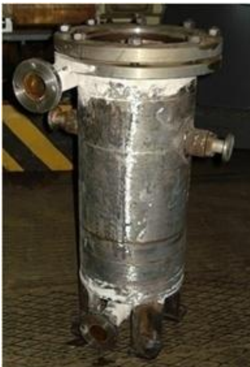
Рисунок 5.11 – Внешний вид медного водоохлаждаемого кокиля диаметром 150 мм
