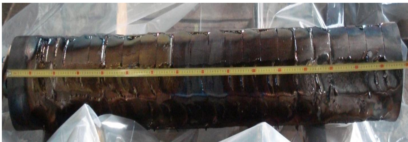
Рисунок 4.3 – Внешний вид промышленного расходуемого электрода (заготовки) диаметром 200 мм
